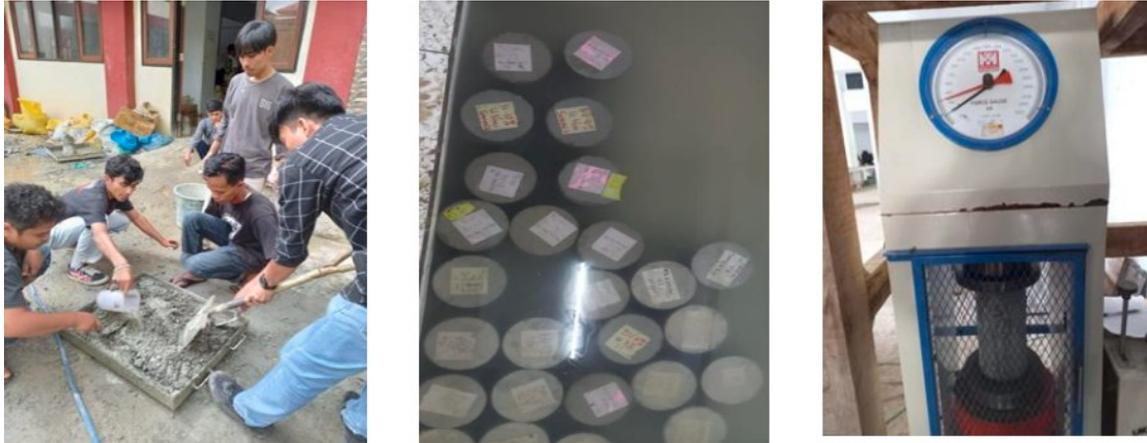
**Gambar 4** Proses pencetakan, perendaman dan pengujian beton
