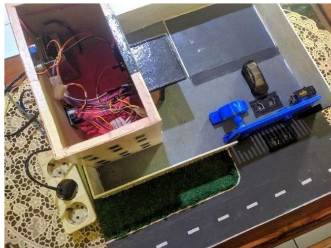
Gambar 4.1 Gambar Awal Prototype Gerbang Dengan Kontrol Android
