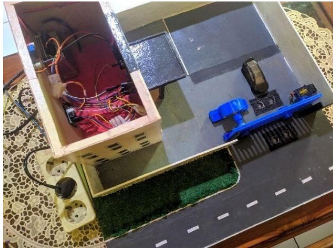
Gambar 3.16 Prototype Gerbang Dengan Kontrol Android
