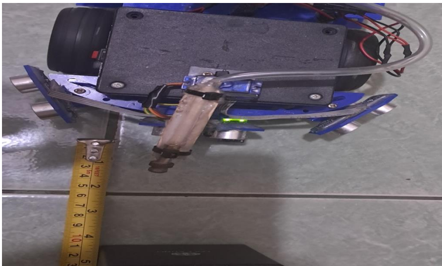
Gambar 7. Pengujian Sensor Ultrasonic 2 jarak benda 11 cm
