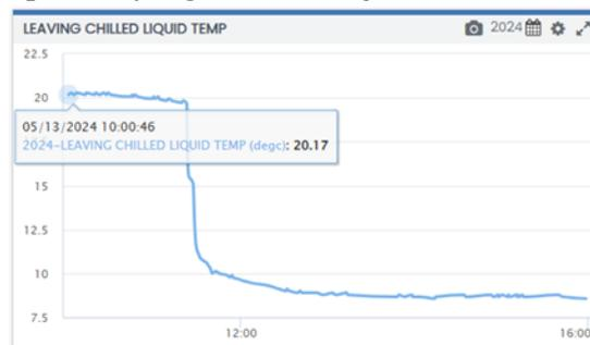
Gambar 3. Temperatur air keluar dari Evaporator
