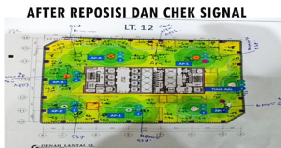
Gambar 4. Asesmen Setelah Optimasi Acces Point Wlan
