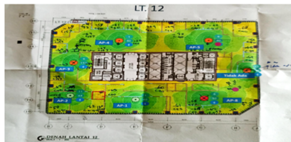
Gambar 2. Asesmen sebelem Optimasi Wlan
