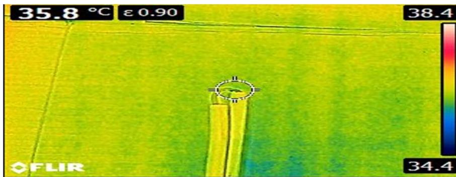
Gambar 11. Penekukan Kabel Sebesar 0° (tekuk balik)
