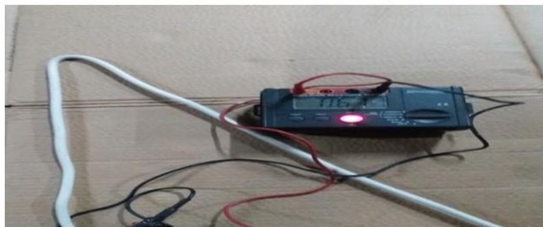
Gambar 18. Penekukan Kabel Sebesar  $30^\circ$
