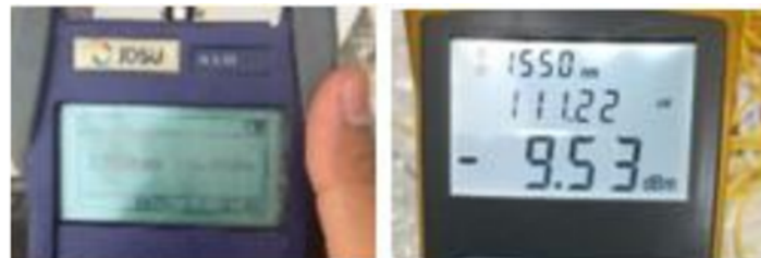
Gambar 18. Pengukuran besar redaman jalur dengan OLS (kiri) OPM (kanan)
