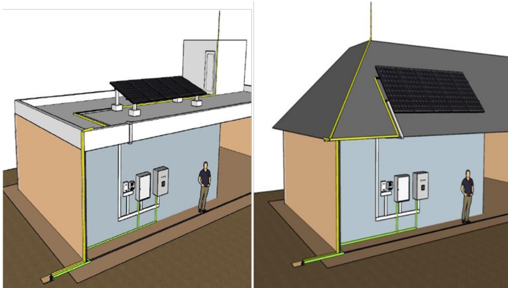
Gambar 1. Penempatan Komponen PLTS Sistem On grid
