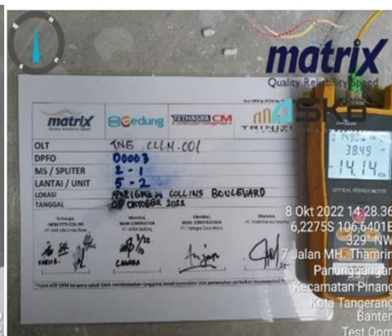
(Gambar 10. Pemasangan Roset di sisi Kamar Customer) (Gambar 11. Pengetesan Redaman Loss db di Roset Kamar Customer)
