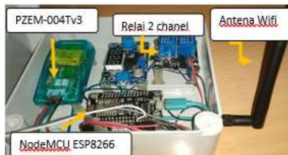
Gambar 3. Tampak dalam box rangkaian modul kontrol dan monitoring
