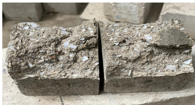
Gambar 4. Kondisi benda uji pasca uji tekan
