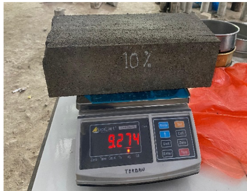
Gambar 5 Pengujian daya serap air
