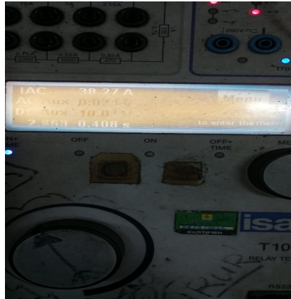
Gambar 8 Hasil Pengujian Test Proteksi Relay Waktu MOC.
