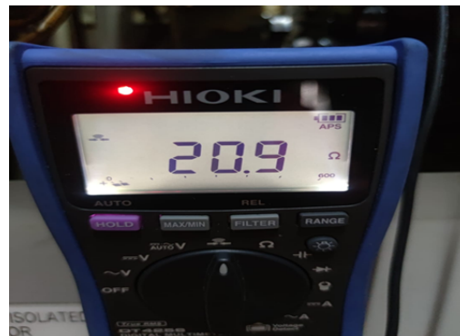
Gambar 3 Gambar Hasil Nilai Tahanan Tripping Coil Open Penyulang Kaca Piring
