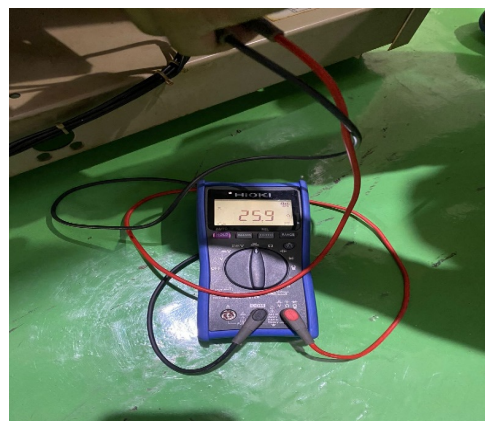
Gambar 4 Gambar Hasil Nilai Tahanan Tripping Coil Close Penyulang Kaca Piring
