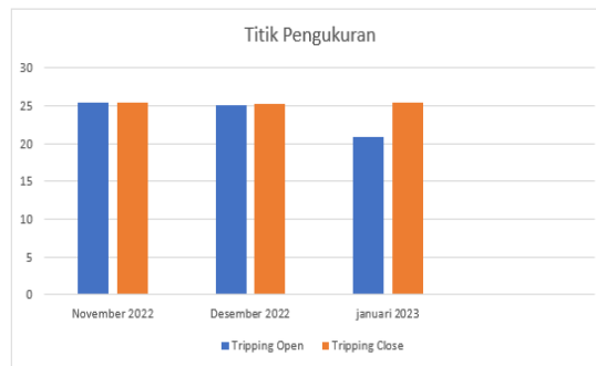
Gambar 4. 1 Hasil Pengukuran Tahanan Tripping Coil Open dan Close
