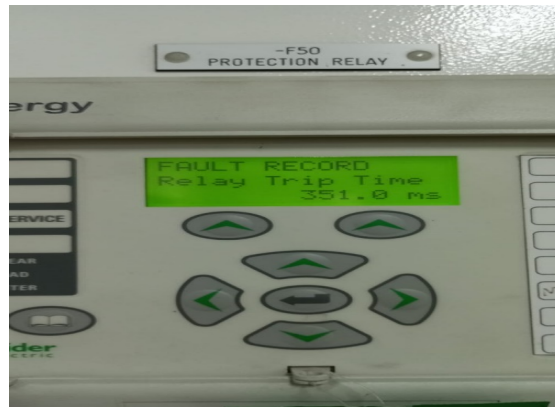
Gambar Hasil Waktu Pengujian Test Proteksi Relay Tanpa PMT
