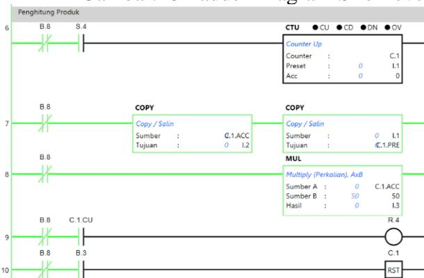
Gambar.19 Ladder Diagram Penghitung Hasil Produk
