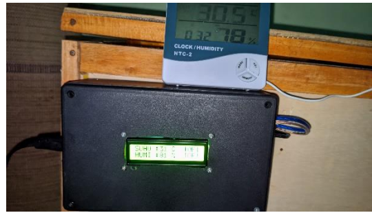
Gambar 15. Proses pengujian respon sensor DHT22
