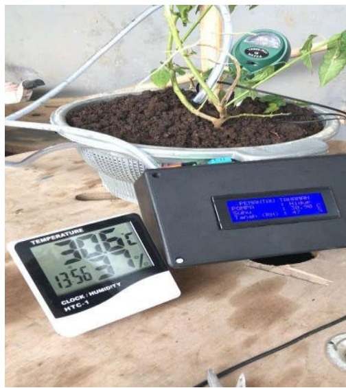
Gambar 4. Pengukuran Suhu Disekitar Tanaman Cabai Menggunakan Thermometer Digital dan Sensor DHT 11
