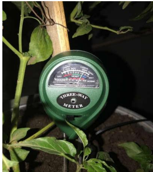
Gambar 1. Pengukuran Kelembaban Tanah Menggunakan Alat Manual di Pasaran
