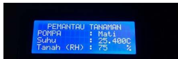
Gambar2. Pengukuran Kelembaban Tanah dan Suhu Menggunakan Alat Yang Dibuat
