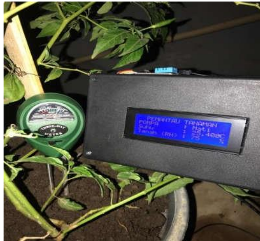
Gambar 3. Pengukuran Kelembaban Tanah Menggunakan 2 Alat (Manual dan Alat Yang Dibuat)
