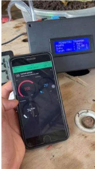
Gambar 5. Pengukuran Kelembaban Menggunakan Jaringan WAN
