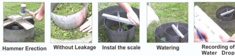
Gambar 1 B : Pemasangan “Double Ring Infiltrometer”
