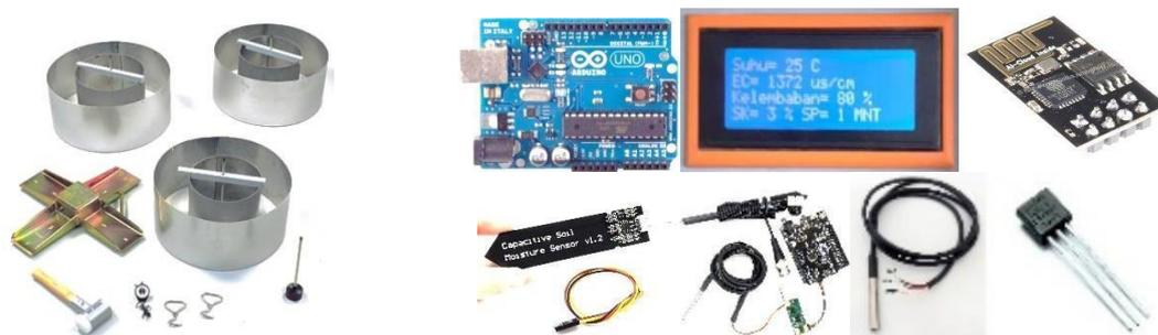
Gambar 1 : Double Ring Infiltrometer & Sensors
